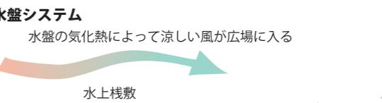
水盤の水は棧敷下部に設けられた地下ポンプピットから一番高い棧敷へと上げられ、下池に向かって自然流れします。下池に溜まった水は滌過機械室・地下ポンプピットへと集水され、浄化・循環する計画とします。下池は受水槽として機能し、掃除等のメンテナンスコストを抑えるよう配慮します。また、棧敷から下池へと循環する水の気化熱により、広場に涼風の流れるまちなかのオアシスのような場所をつくります。
